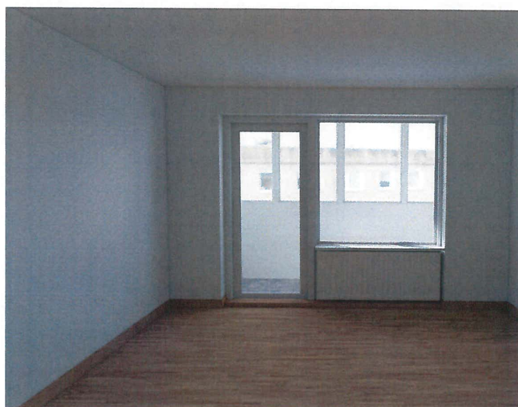
Lysberegning og visualisering af de eksisterende forhold med lukket altan og brystning. Som det ses er det naturlige lys dårligt ind i bunden af stuen, og fremstår mørk.
